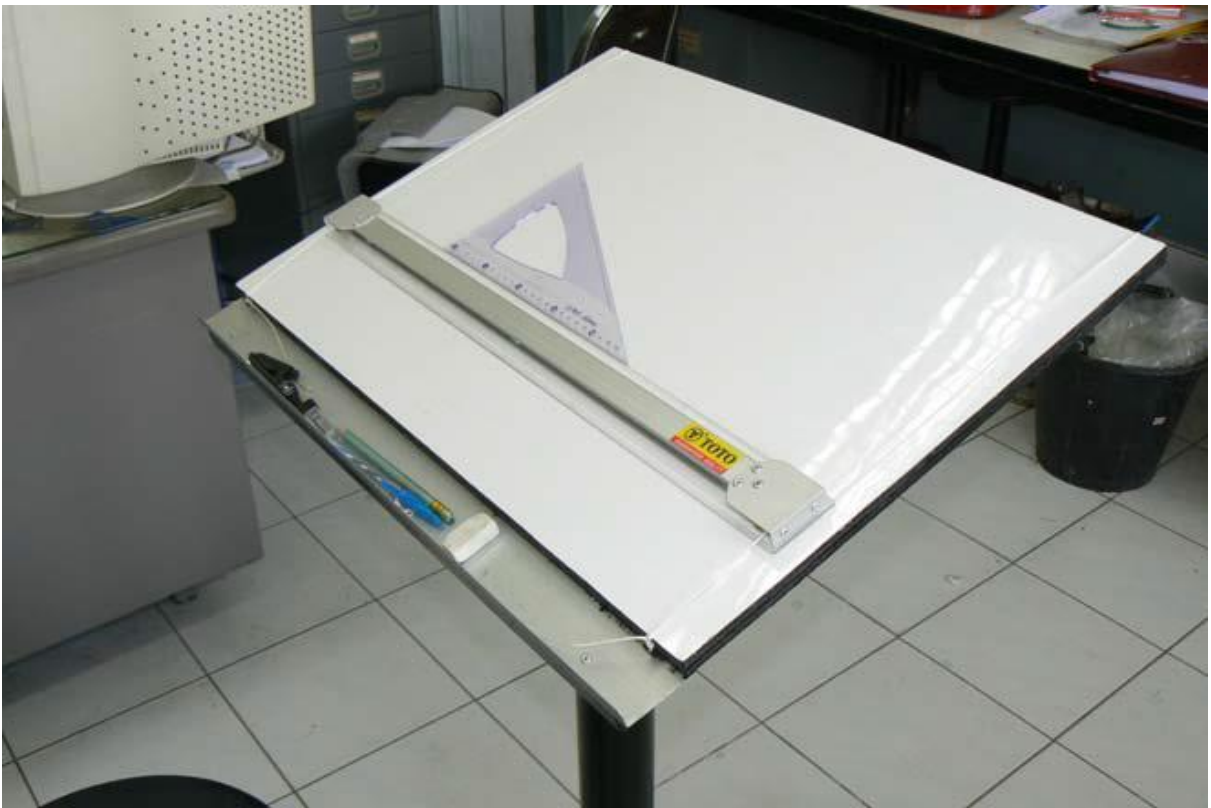
รูปแสดงทิสไลด์ที่ติดตั้งบนโต๊ะเขียนแบบ
